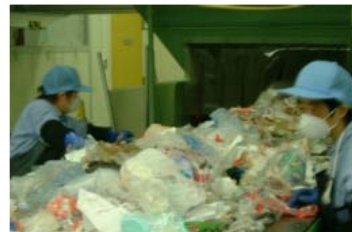
「廃プラの手選別作業です。」
